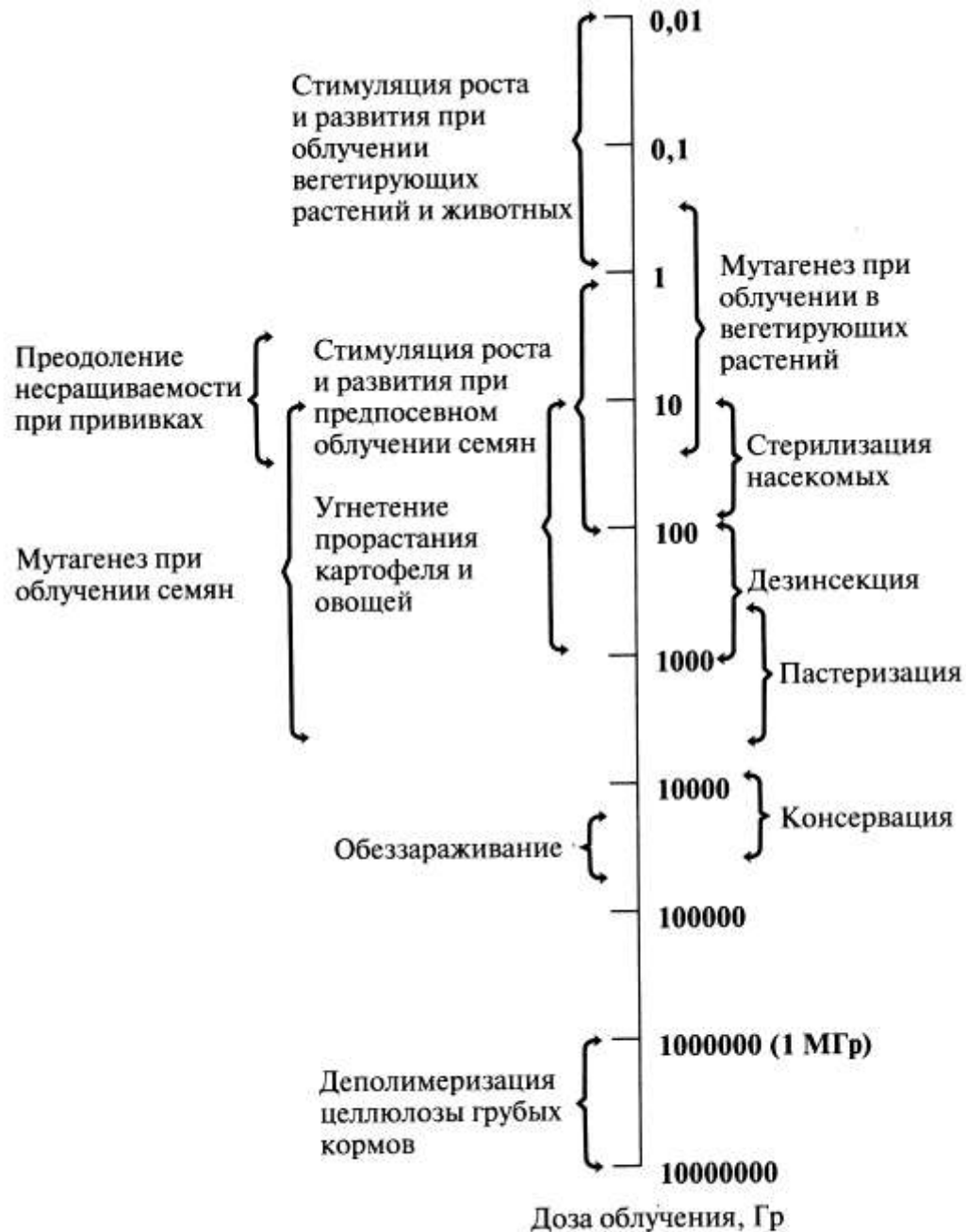
Рис. 4.5. Диапазон доз \gamma -излучения, используемых в радиационных технологиях в сельском хозяйстве и пищевой промышленности (Гудков, 1991)
