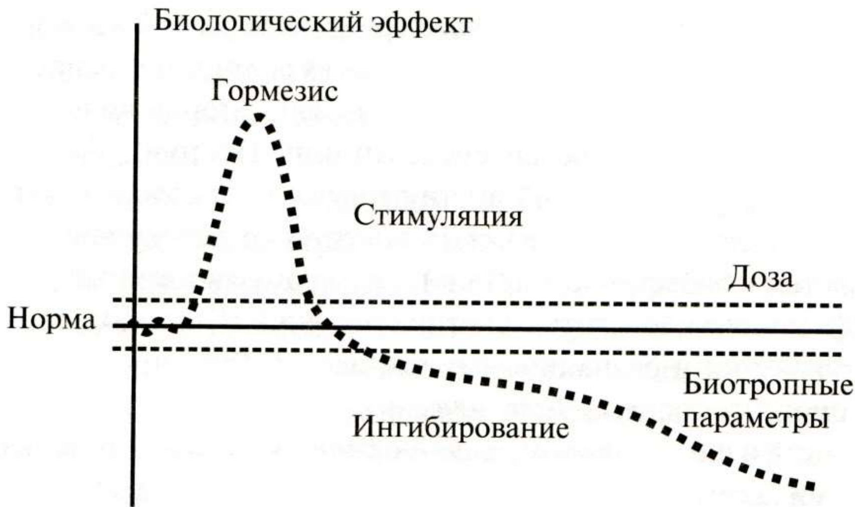
Рис. 1.6. Общий вид зависимости биологического эффекта от уровня (поглощенной дозы ионизирующего излучения, биотропных параметров неионизирующих излучений) воздействующего фактора
